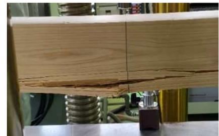
実際に使用する大きさの木材を、繊維方向を水平にした状態で、鉛直方向に荷重をかけたときの最大荷重等を測定し、柱や梁桁で使用する木材強度の考え方等を確認しました。
