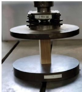
繊維方向や含水量等の条件を変えた試験体を圧縮して、その最大荷重等を測定し、木材の性質について確認しました。
